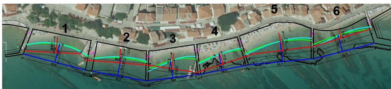
Slika 20. Geometrijski parametri zaklonjenosti minijaturnih žala uz ulicu Palada (plava linija – projektirano, crvena linija – postojeće)
