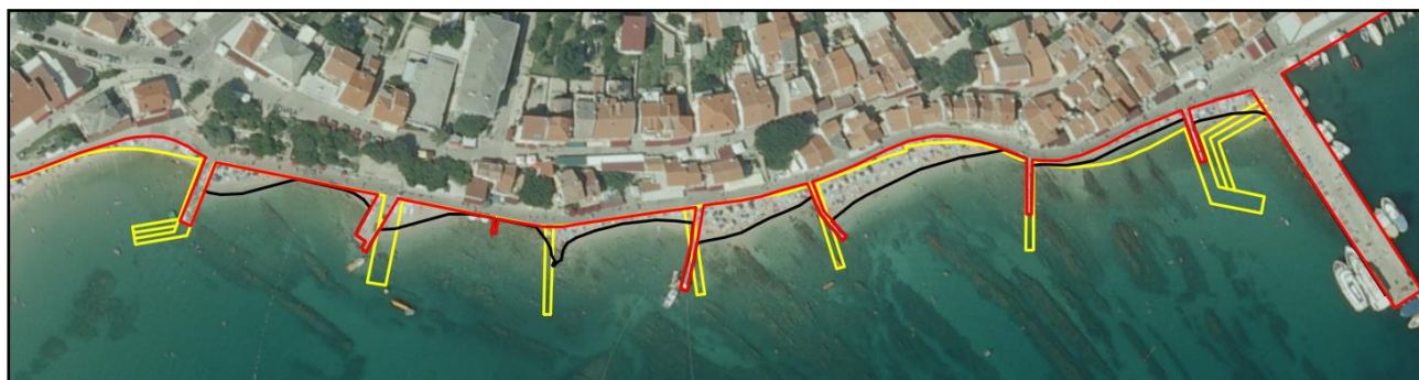
Slika 2. Palada – postojeće stanje obalne linije (crna), zidovi – koeficijent refleksije 0,90 (crveno); konture projektiranih objekata (žuto)
